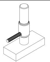
AVOID OR MINIMIZE TORQUE **DURING INSTALLATION**
